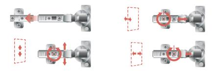
Sie können den Push-to-Open-Stift drehen. Dadurch wird die Tür weiter nach innen oder nach außen geschlossen. Das können Sie auch ausprobieren, wenn das Push-to-Open-System nicht richtig funktioniert. Der Stift erhält dann mehr oder weniger Platz, um richtig ein- und auszuschieben.
